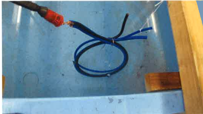
写真7 耐荷重試験後の耐電圧試験（水中浸漬）
