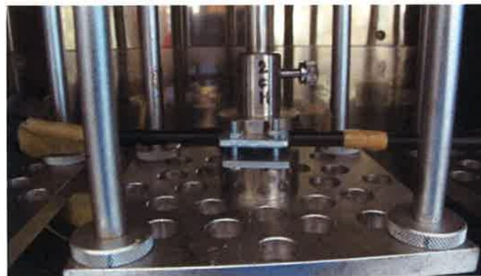
写真 3 0 試料を 183℃ の加熱変形試験機に入れた状況。荷重は 2 本で 1 N
