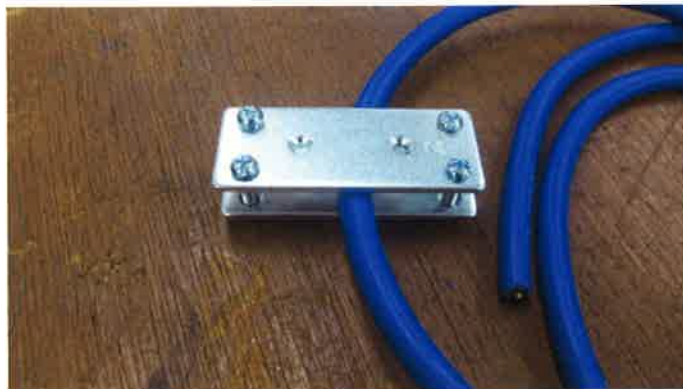
写真 3 6 50Nの荷重は試料長さ30mmに加えた。
