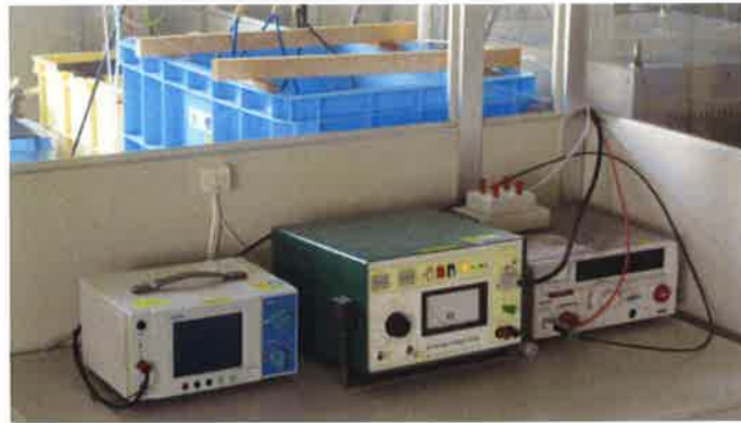
写真1 耐電圧試験の全景
