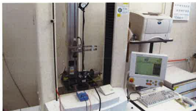
写真15 同上（テスターの導通チェックで破断検知）
