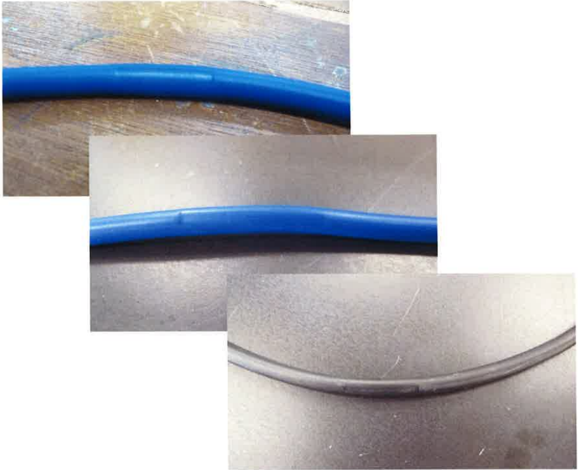
写真38 113℃・50Nで変形した試料
