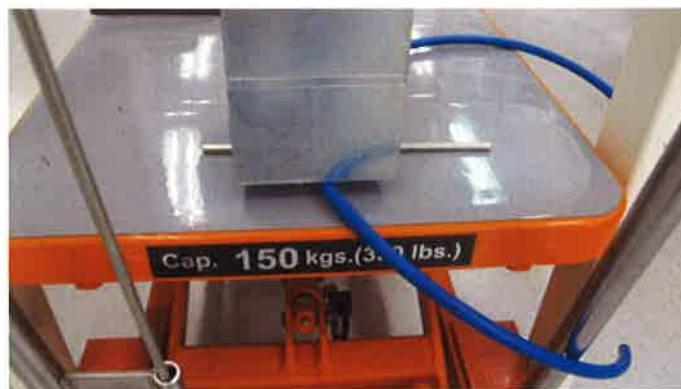
写真5 6mmφの鋼線上の試料に600Nの荷重を印加
