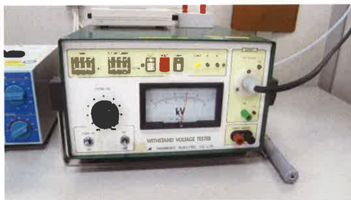
写真39 導通チェックと耐電圧試験
