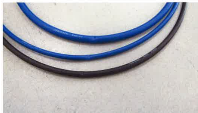
写真6 600Nの荷重で変形した試料(荷重除去直後は変形大であった。)
