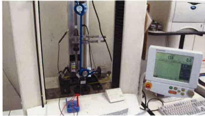
写真13 引張試験実施状況（テスターの導通チェックで破断検知）
