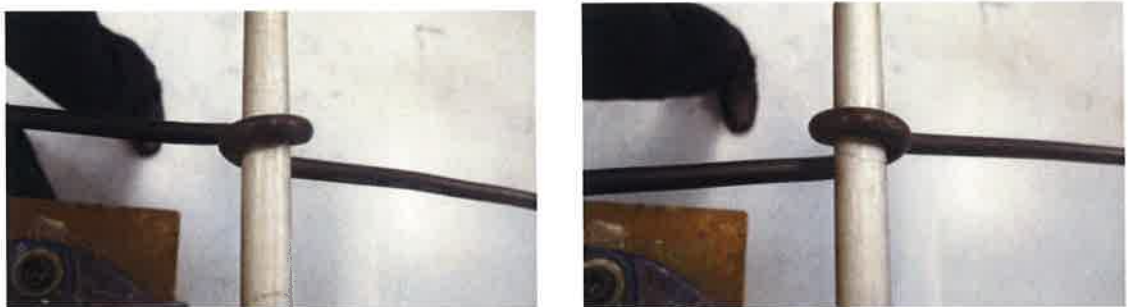
写真18 同上（同一試料を±180度方向に曲げている。）
