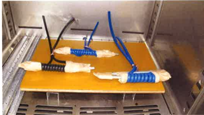
写真 2 3 5回巻付けた試料を120℃の高温槽にいれた状態
