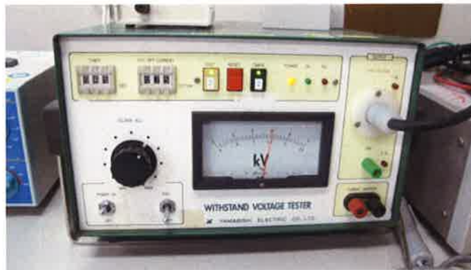
写真 2 1 曲げ試験後の耐電圧試験（AC1500V/1分）
