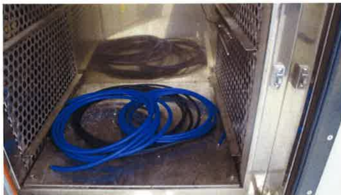
写真 2 7 低温槽の試料を入れた状態 (-10℃)
