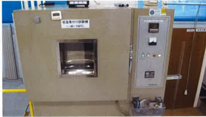
写真 2 6 低温巻付試験に使用した低温槽
