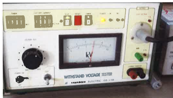
写真3 AC1500V・1分間を課電している状況
