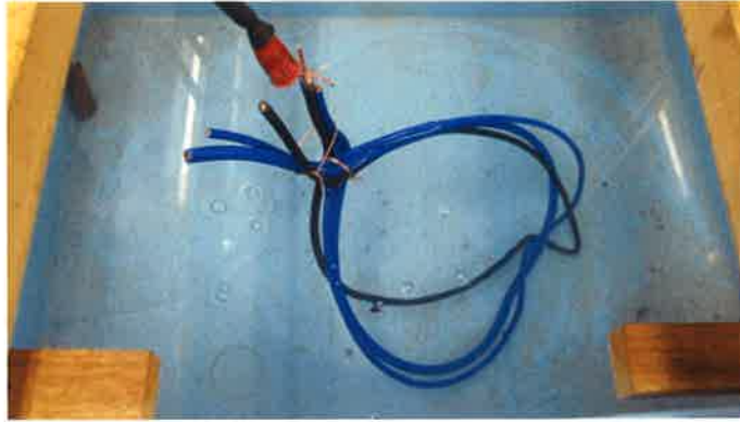
写真 2 0 曲げ試験後の耐電圧試験（水中浸漬）
