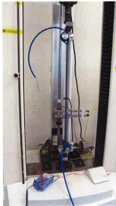
写真14 同上（テスターの導通チェックで破断検知）
