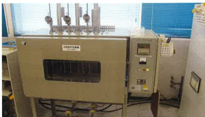
写真 3 4 使用した加熱変形試験装置の外観
