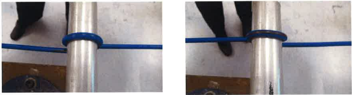
写真17 同上（同一試料を±180度方向に曲げている。）
