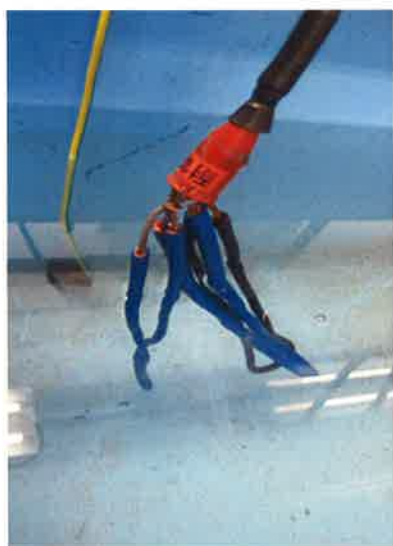
写真 3 3 耐加熱性能試験後の耐電圧試験
