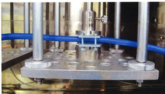
写真 3 7 113℃の高温槽内で50Nの荷重を加えた。
