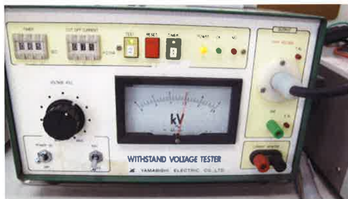
写真8 耐荷重試験後の耐電圧試験（AC1500V課電）
