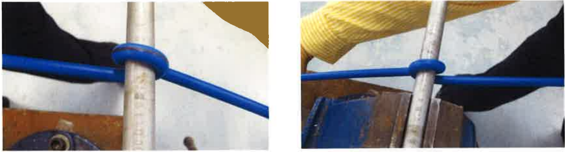
写真16 曲げ試験の状況（同一試料を±180度方向に曲げている。）
