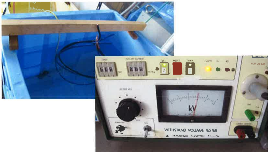
写真12 衝撃荷重試験後の耐電圧試験
