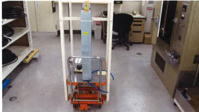
写真4 耐荷重試験機。重りは60kg。12Nを追加して600Nとした。
